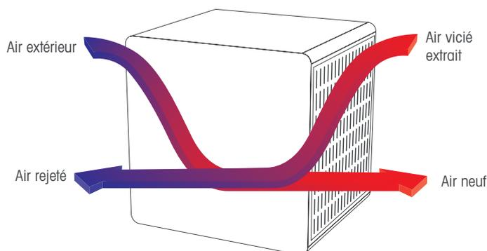
Lorsqu'on cherche à déshumidifier un local comme celui d'une piscine, le moyen le plus simple et le plus économique est d'injecter dans ce local de l'air extérieur (qui ne contient quasiment pas d'humidité).
