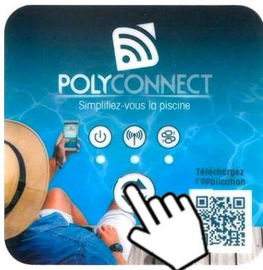
Pulse la tecla
