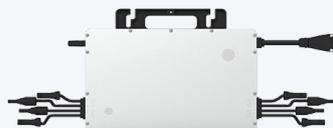
**Micro-onduleur.** Un micro-onduleur est connecté à deux panneaux photovoltaïques.
